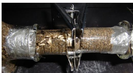
目盛り付きガラス管の中央部にシートを挟み込めるように改良した試験装置
