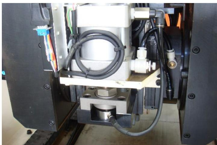
図6 接合ヘッドにおけるロードセル取り付け部
