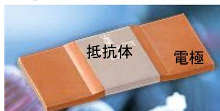
金属抵抗材であるCu-Ni合金やNi-Cr合金などと、電極材であるCuとの異種難接合材料同士の溶接に 図1 電流検出用低抵抗固定抵抗器は、電子ビームで突合せ溶接する方法が一部で採用されている。
