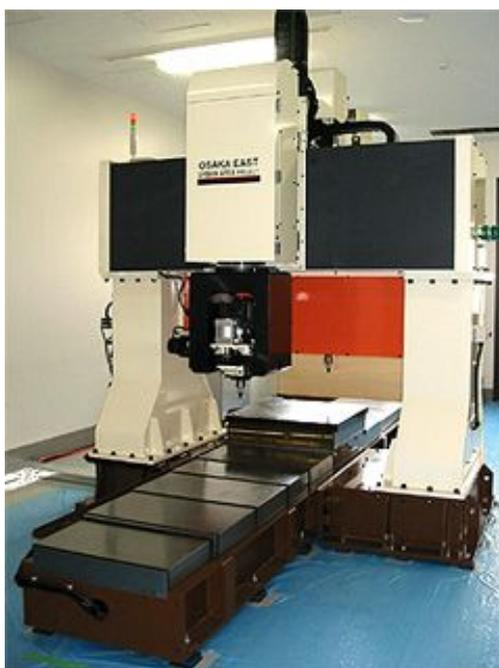
図4 既存の摩擦攪拌接合装置
