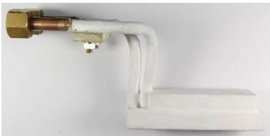
図 2 - 3 加熱コイル（摩擦攪拌接合用）
