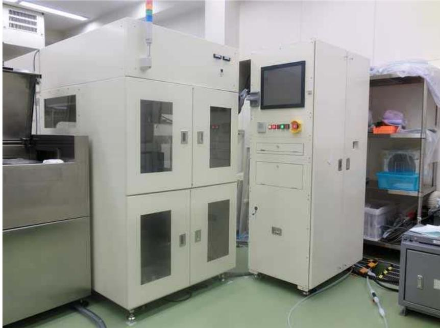
図 2-3-1-1 ウエットエッチング装置外観
