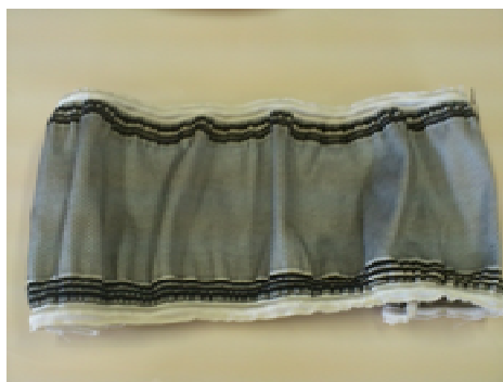
図 3 本体、両サイド生地を同時に製織した一体製織織物
