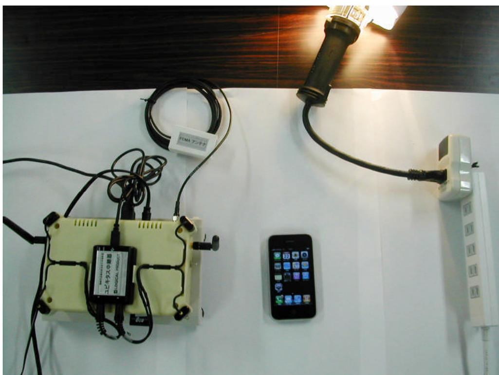
写真2 スマートフォン (Bluetooth) による IrDA 機器の制御 (点灯)
