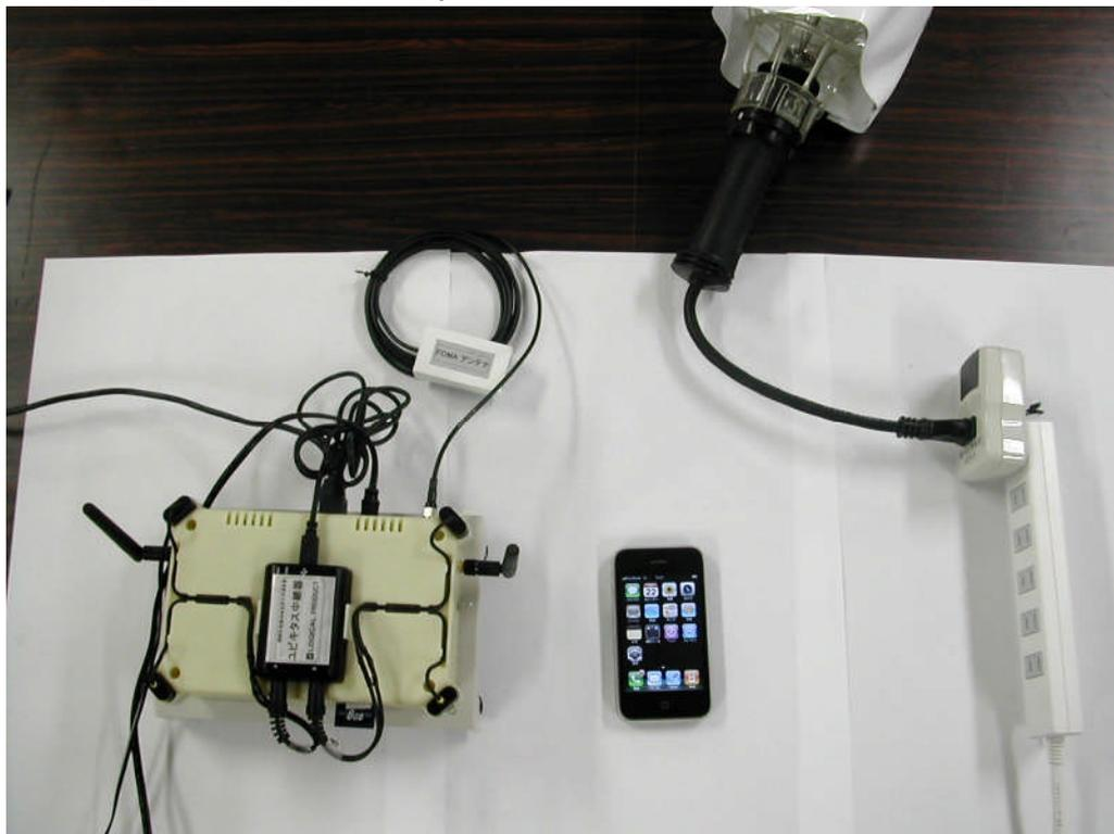
写真1 スマートフォン (Bluetooth) による IrDA 機器の制御 (消灯)
