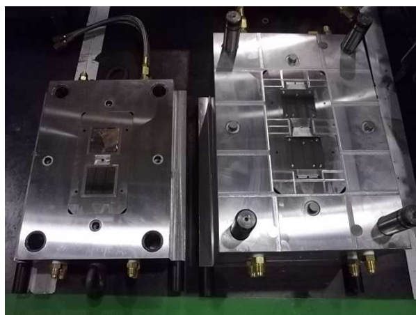
図 2-1-3 Y 字流路プレート用金型の外観写真
