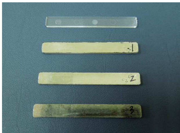
図 2-2-7 光反応性トリアジンジチオール処理によるNiメッキされたCOP樹脂プレート (最上段はNiメッキ未処理、下3つはNiメッキ処理品)
