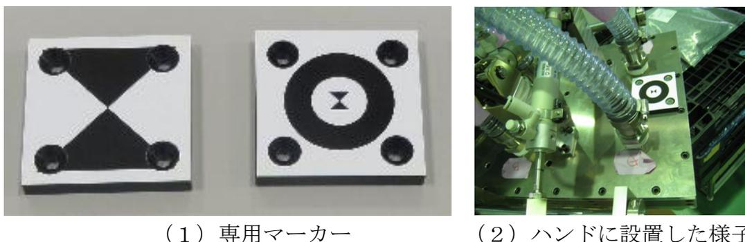
図 4.1-9 ロボット-カメラキャリブレーション専用マーカー
