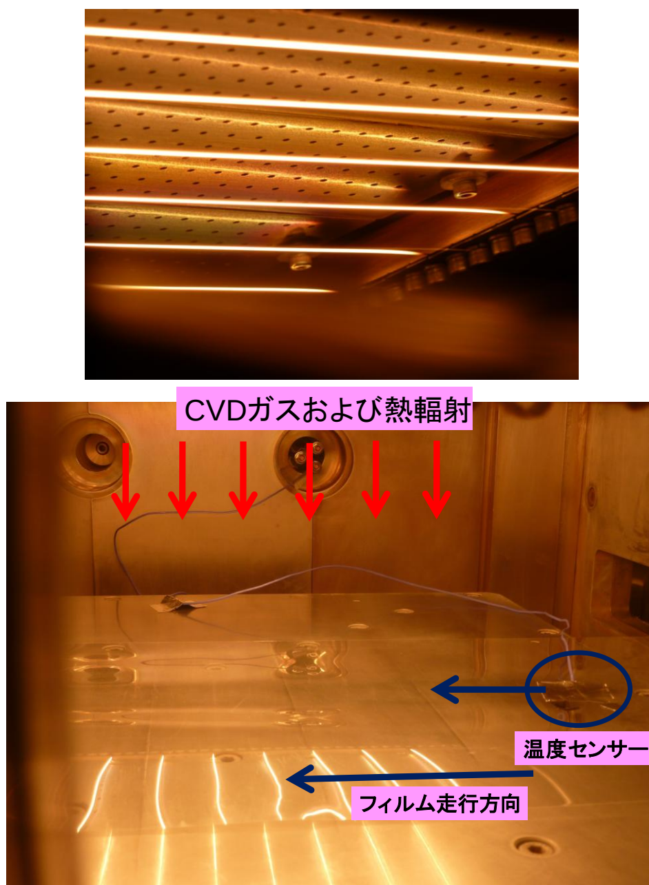
写真 1. 有機触媒 CVD 装置のフィラメントモジュール（上）と フィルム走行時の温度計測の説明用写真（下）
