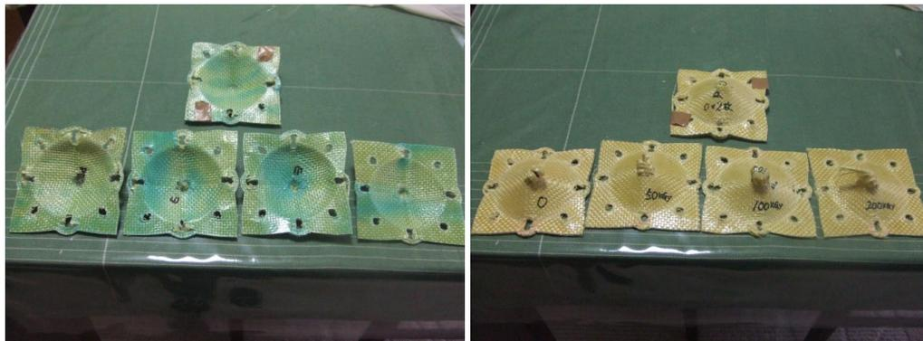
写真5 AF 織物 PE 樹脂成形体の落錘衝撃試験結果
