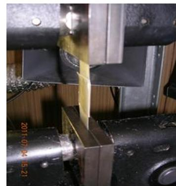
写真1 接着力の測定
