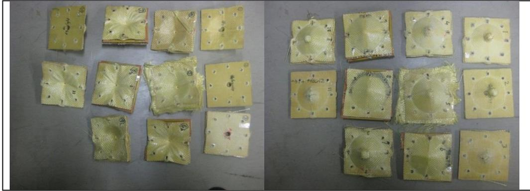
写真4 KV 積層板の落錘衝撃試験結果
