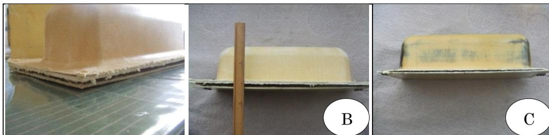
写真10 筐体の上下接合部の隙間
