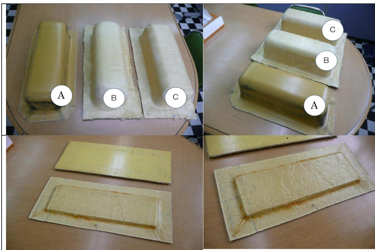
写真9 筐体成形用上部・側面部と底部の成形例
