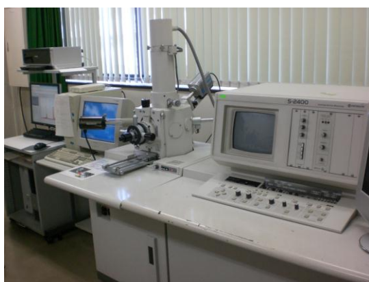
図 2-2-15 EDX (energy dispersive X-ray spectrometry) 装置
