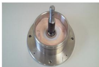
図 2-3-35 試験片の取り付け
