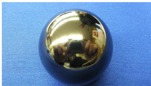
写真 1-4-1 試作開発した骨頭球
