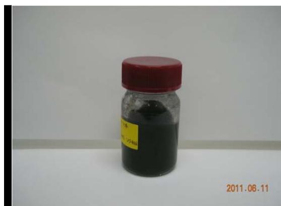
写真 11 重合装置反応 60 分 超音波 90 分
