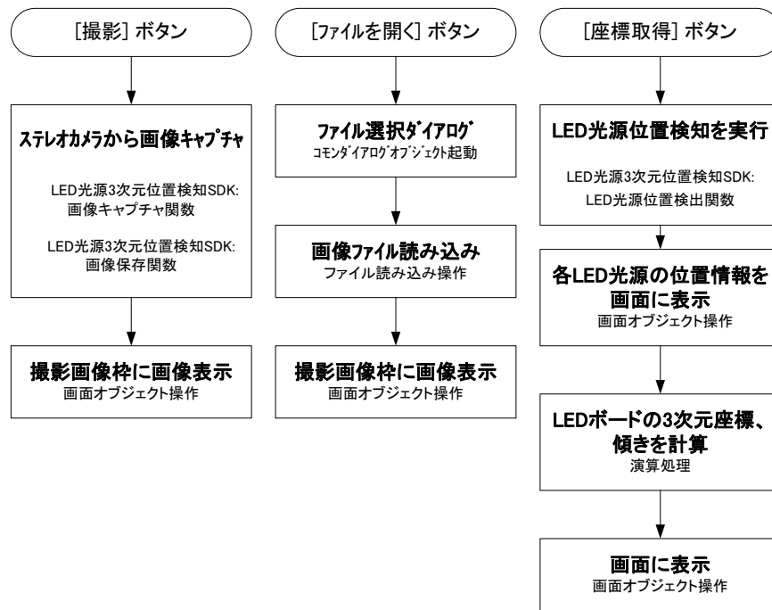
図 10 LED 光源 3 次元位置認識ソフトウェアの内部処理フロー
