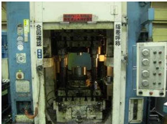
図 1-5 プレス機内部のダイセット
