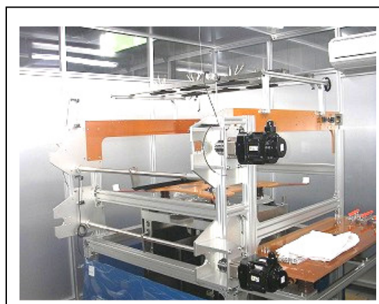
巻き出し・巻き取り部
