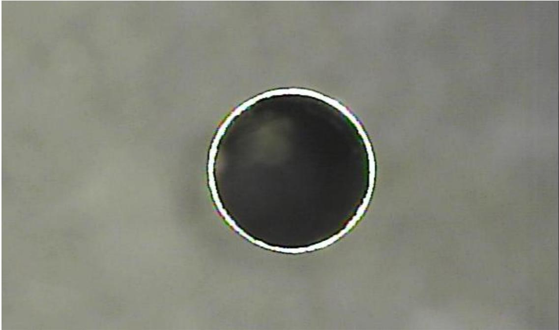
外径φ2.26mm 内径2.1mm パイプ肉厚0.08mm (80 ミクロン)
