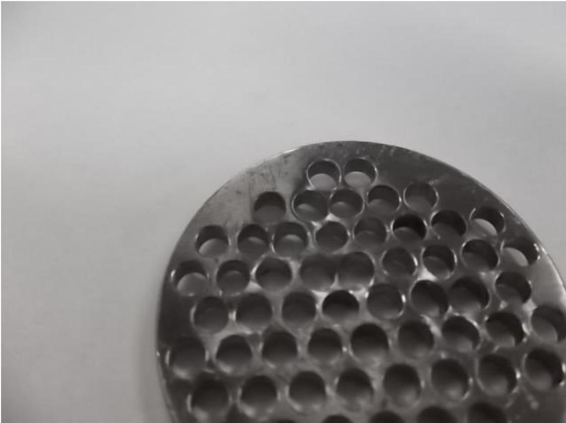
2-2-2 金型の設計変更をして全ての穴を同時に、3段階で打ち抜く
