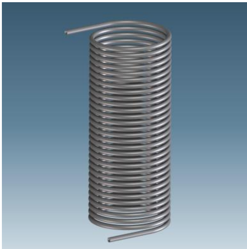
図 2.2 考案したらせん状の熱交換器
