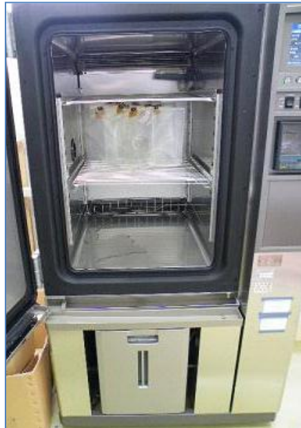
写真4 恒温・恒湿器 (株)エスペック製 (PR-2KP) 設置場所・・・河村産業(株)
