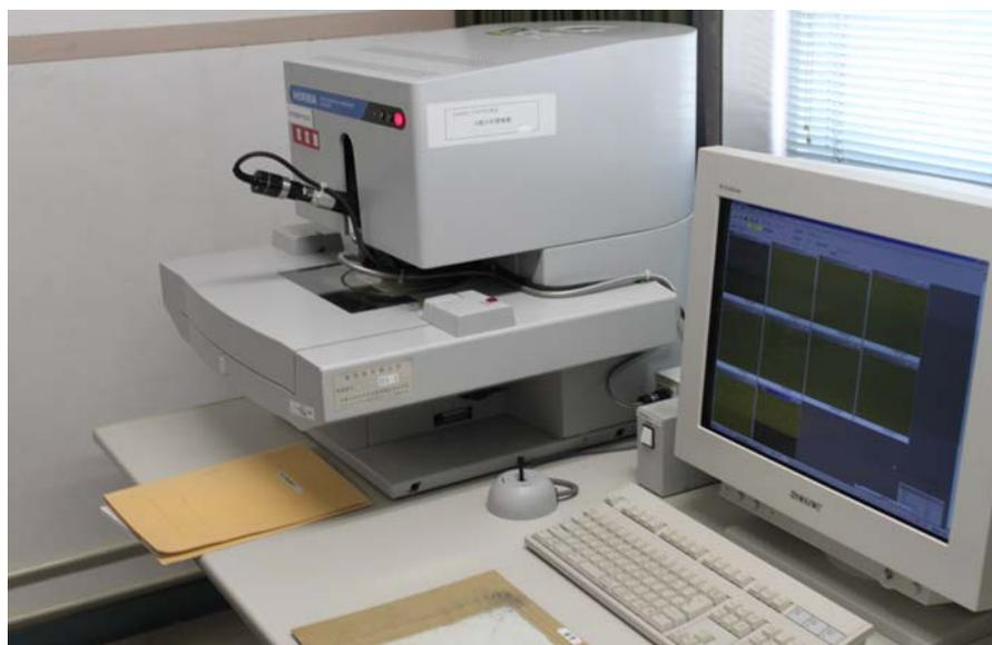
図 1 X線透過型顕微鏡（三重県工業研究所殿）
