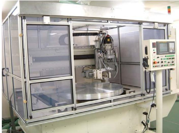
図1 溝修正加工装置
