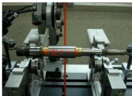
写真502：動釣り合い試験機による中空ロータのバランス調整
