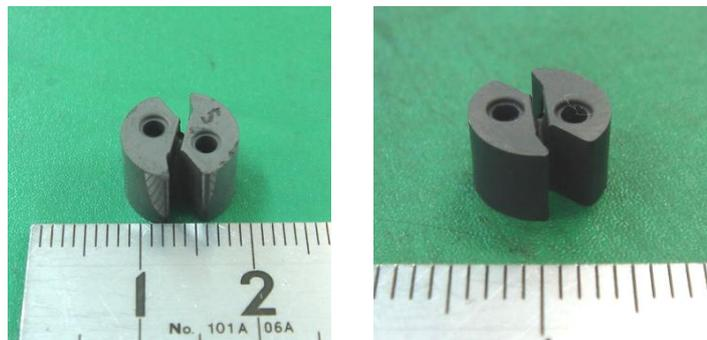
図207 刃先交換型成形体（左）と焼結体（右）の外観
