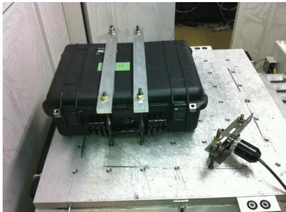
図2.45 二次試作機 垂直振動設定
