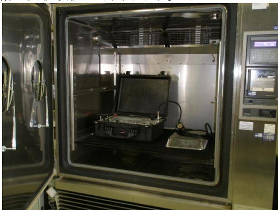
図2.50 恒温槽と供試体
