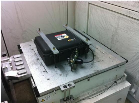
図2.43 一次試作機 水平振動設定
