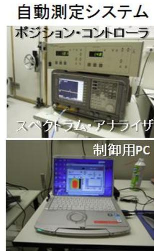
図2. 32 電波暗室における電磁界分布測定
