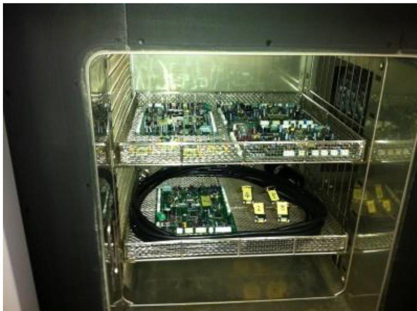
図2.49 熱衝撃試験機収納状況
