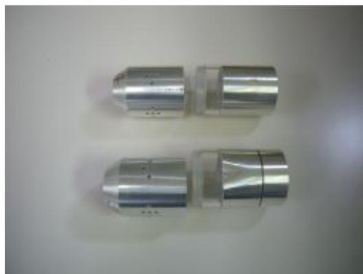
図 2. 5 3 せん断試験後の供試体
