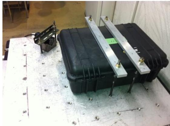
図2.46 二次試作機 水平振動設定
