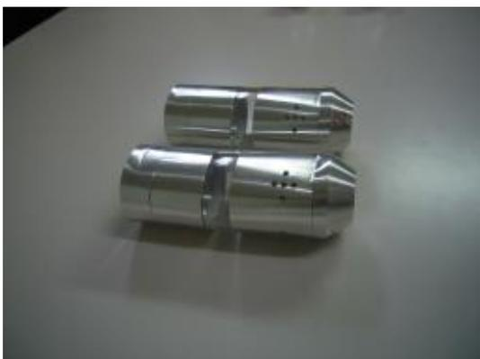
図 2. 5 2 圧縮試験後の供試体
