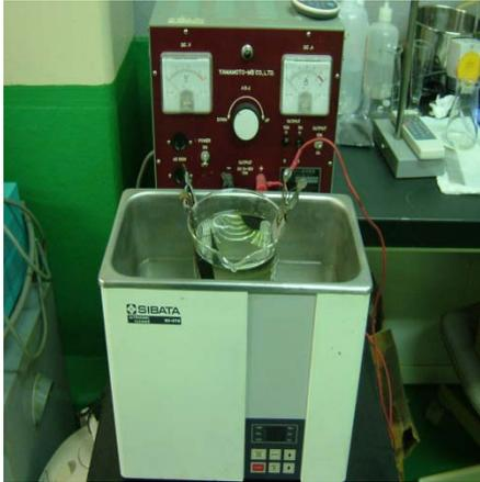
写真5 超音波攪拌試験状況
