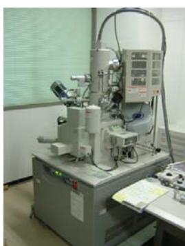
写真3 超分解能電解放射型走査型電子顕微鏡
