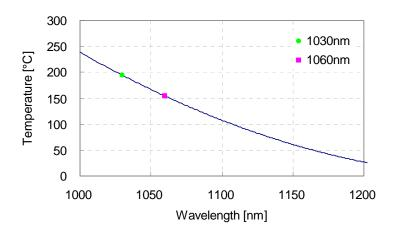
図 2-13 LBOの x 軸における 90 度位相整合温度条件
