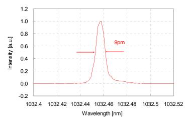
図 2-3 CW 発振 LD の光スペクトル
