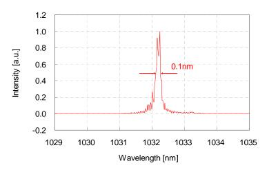
図 2-5 パルス発振LD を FBG でロックした光スペクトル
