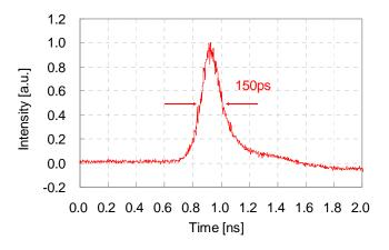
図2-6 ゲインスイッチングによるピコ秒発生の様子
