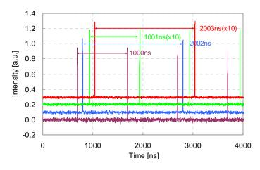
図2-2 発振器からの光パルス a) パルス幅、b) パルス繰返し
