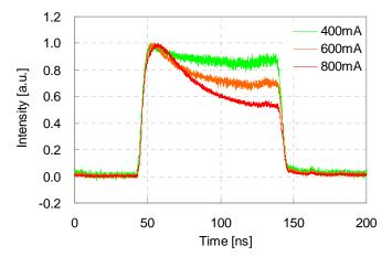
図2-9 プリアンプ2段目の増幅によるパルス形状変化
