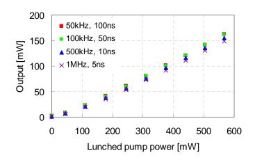
図2-8 プリアンプ2段目の入出力特性
