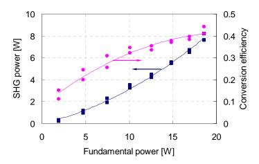
図 2-14 1032nm 基本波入力に対する 516nm SHG 光出力と変換効率
