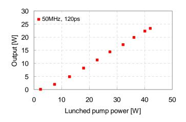
図2-11 ピコ秒・パワーアンプの入出力特性
