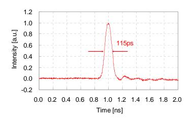
図2-7 外部変調によるピコ秒発生の様子
