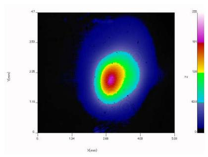
図 2-12 平均出力 20W 以上時のパワーアンプのビームプロファイル
