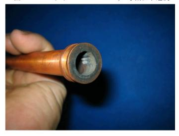
図 2-1 3 10inch バレル閉塞現象 (材料: Ti)
