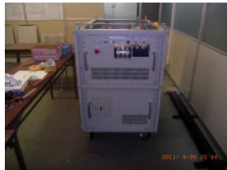
写真2 回生コンバータシステム
