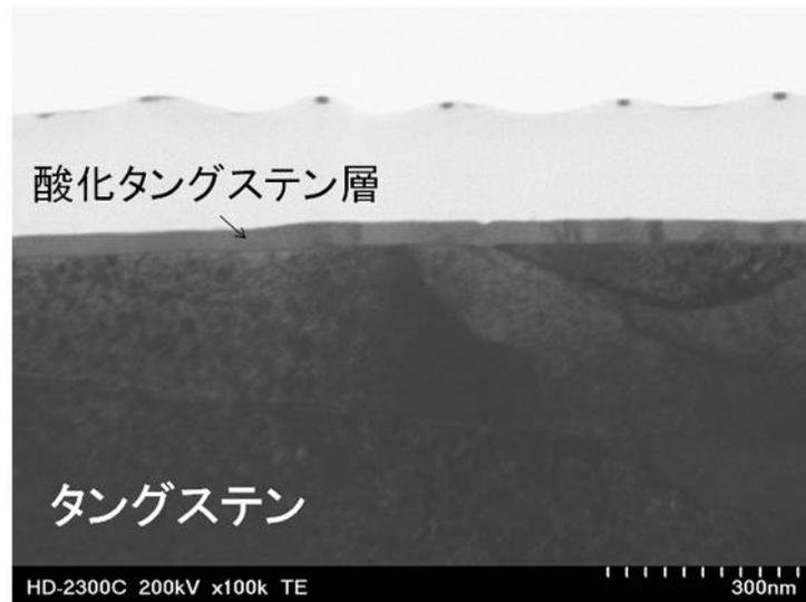
図 2-1 : ラジカル酸化タングステン断面 STEM 像
