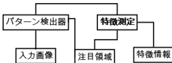
図 2-2 特徴測定の実行フロー
