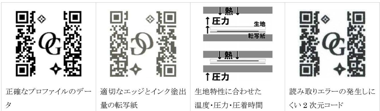
図 1-2-2 読み取りエラーが発生しにくい2次元コードの要件
