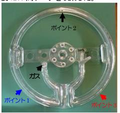
図17(図10) 圧力および温度測定位置
