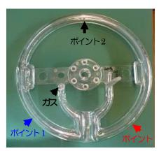
図 10 圧力および温度測定位置
