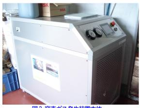
図3 窒素ガス発生装置本体
