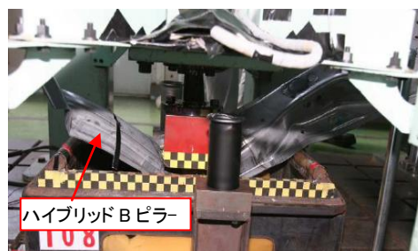
図-22 ハイブリッドBピラー部品衝撃試験
