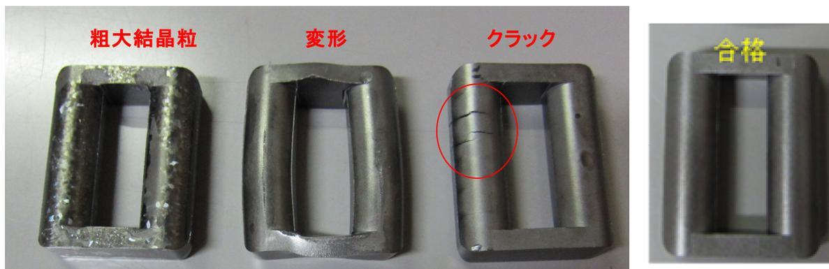
図①-2-3f. 焼成治具がないときの外観不良コアと合格品
