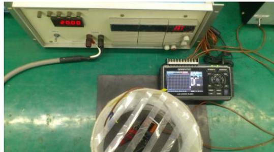
図①-1-7b. 温度上昇測定
