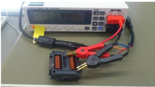
図①-1-7c. 直流抵抗測定
