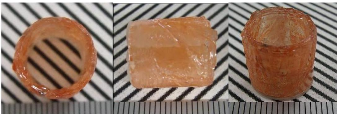
図 2-4-6 育成したチューブ状  $\text{Ca}_3\text{NbGa}_3\text{Si}_2\text{O}_{14}$  結晶。
