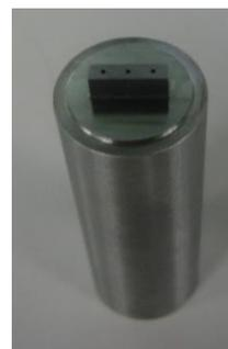
・平板状圧電結晶育成用坩堝(穴3個)の加工(図 2-1-2)
