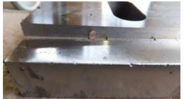
Fig. 102 耐摩耗材料 3 固定刃試驗後(3)
