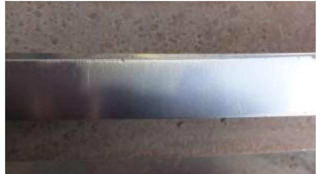
Fig. 100 耐摩耗材料 3 固定刃試驗後(2)
