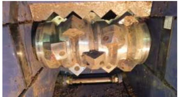
Fig. 48 試験終了後の回転刃およびローター
