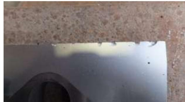
Fig. 90 耐摩耗材料 3 回轉刃試驗後(3)
