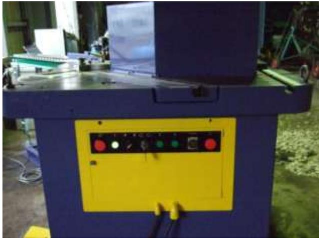
Fig. 32 切断機 操作部
