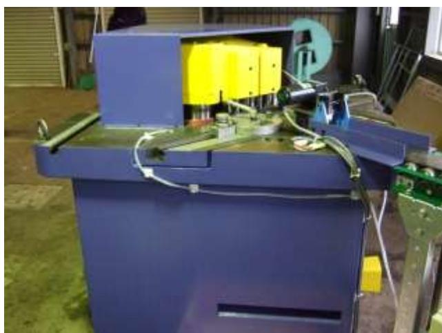
Fig. 30 ギロチン切断試験機装置全景
