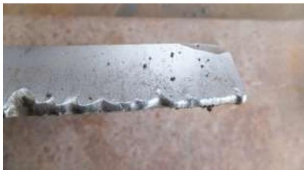
Fig. 103 従来材の回転刃摩耗状態(1)
