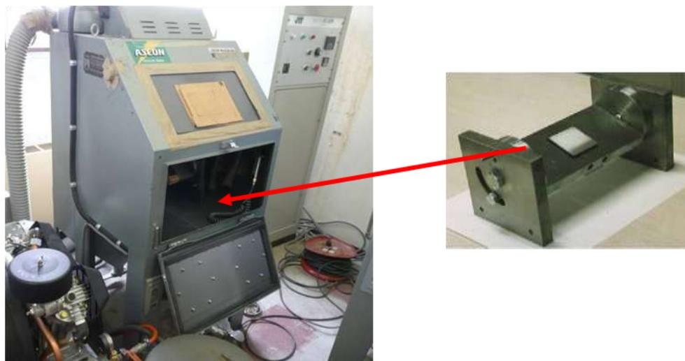
Fig. 19 常温エロージョン摩耗試験機
