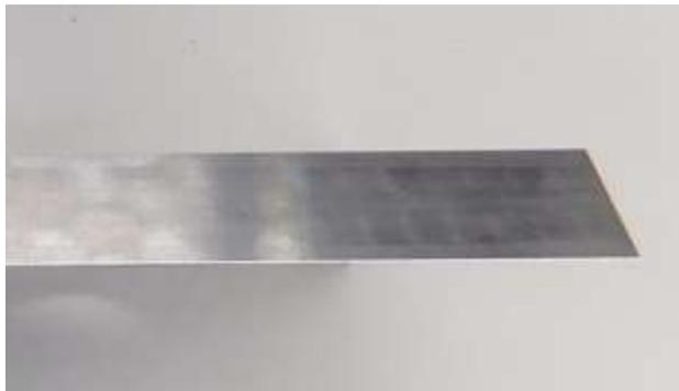
Fig. 93 耐摩耗材料 4 回轉刃試驗前(2)
