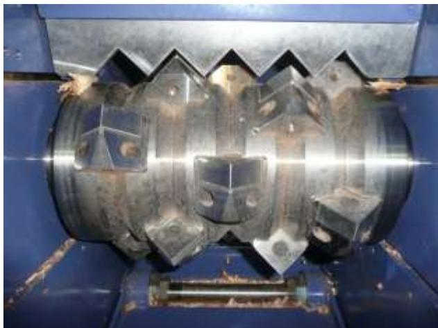
Fig. 24 破砕機ローター部
