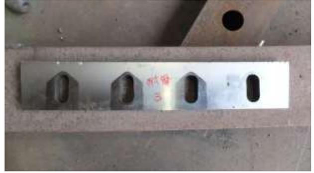
Fig. 86 耐摩耗材料 3 回轉刃試驗後(1)
