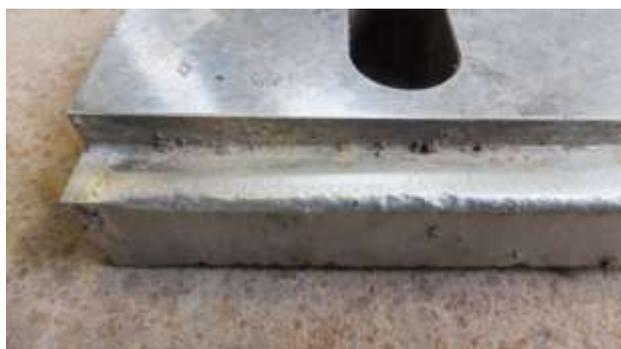
Fig. 105 従来材の固定刃摩耗状態(1)
