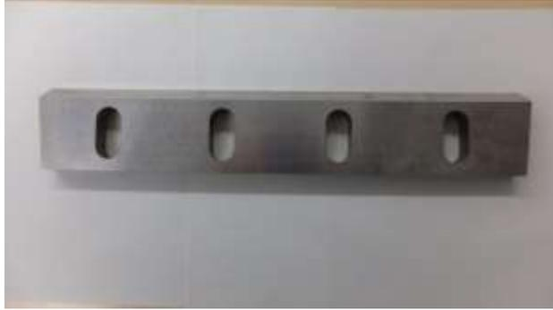
Fig. 91 耐摩耗材料 4 回轉刃試驗前(1)
