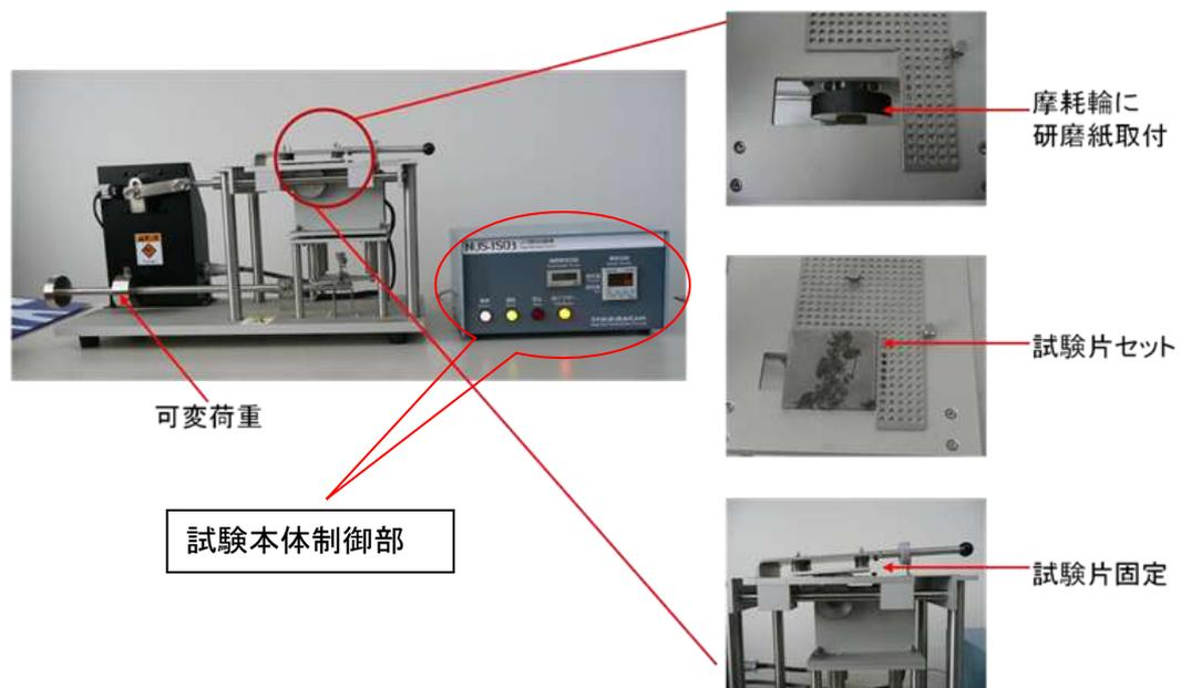
Fig. 7 スガ式摩耗試験機 操作説明図
