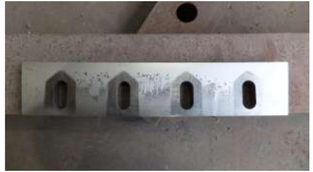
Fig. 80 従来材 回転刃 試験後(1)
