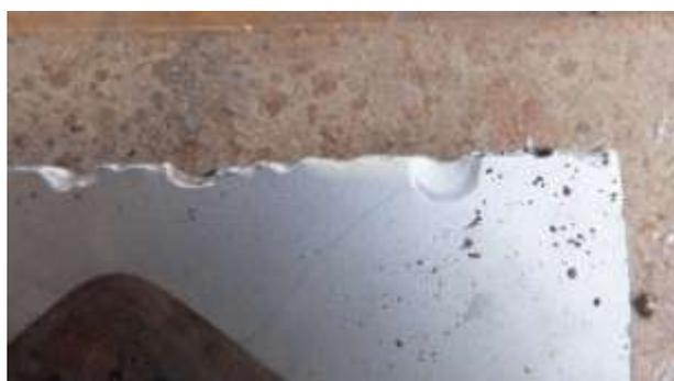
Fig. 104 従来材の回転刃摩耗状態(2)
