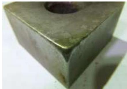
Fig. 50 耐摩耗材料 2 回転刃 試験後
