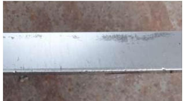
Fig. 82 従来材 回転刃 試験後(2)
