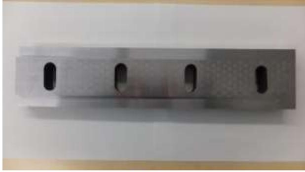
Fig. 97 耐摩耗材料 3 固定刃試驗前(1)
