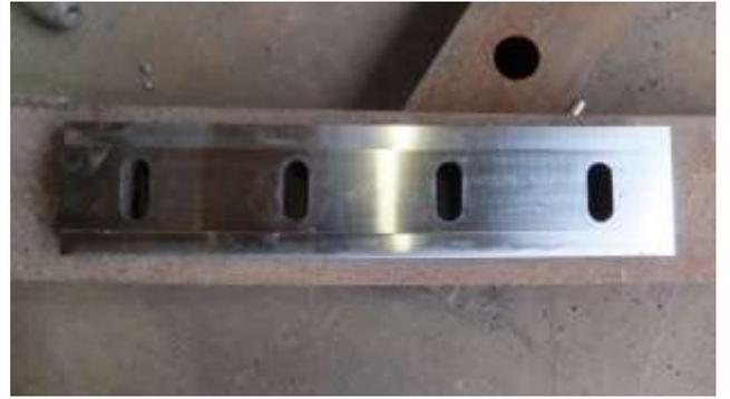
Fig. 98 耐摩耗材料 3 固定刃試驗後(1)
