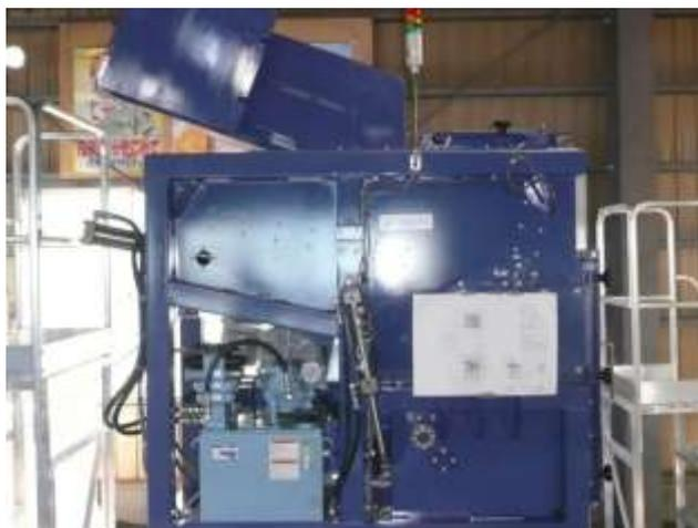
Fig. 36 一軸破碎試験機
