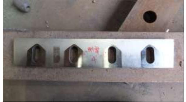
Fig. 92 耐摩耗材料 4 回轉刃試驗後(1)
