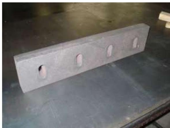
Fig. 73 ミニモジュール 固定刃 加工前
