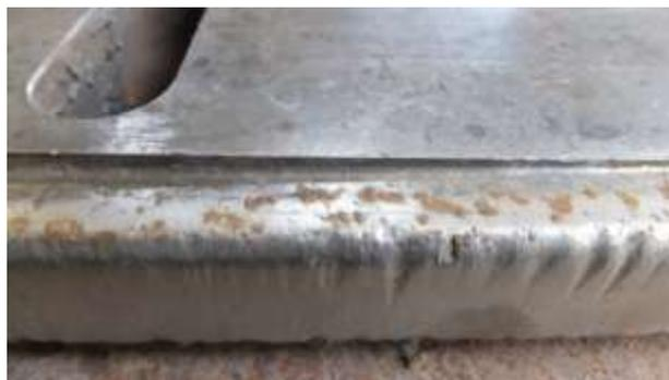
Fig. 106 従来材の固定刃摩耗状態(2)
