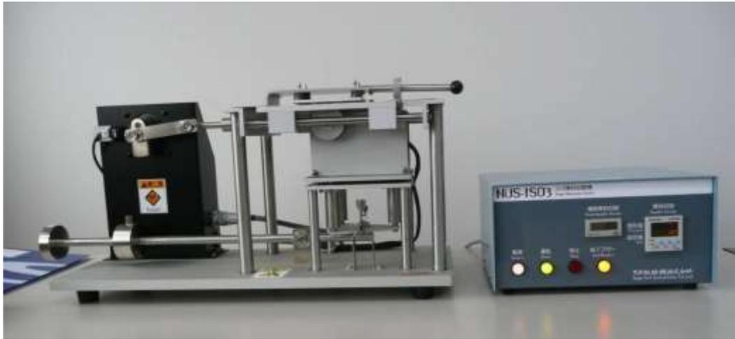
Fig. 5 スガ式摩耗試験機
