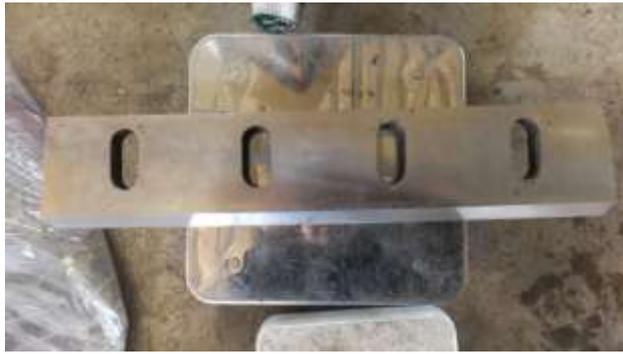
Fig. 79 従来材 回転刃 試験前(1)
