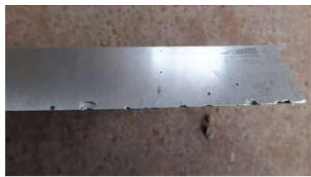
Fig. 88 耐摩耗材料 3 回轉刃試驗後(2)
