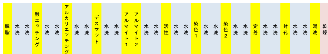
図5：試作装置レイアウト
