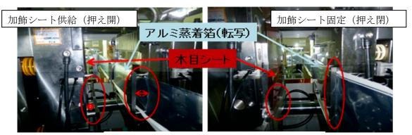
図 2-12 両面加飾シート金型構造と金型内実装
