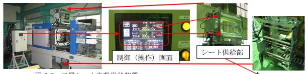
図 3-6 二層シート自動供給装置
