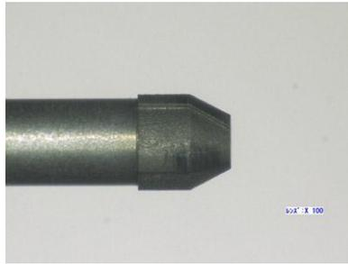
図 3-13 加工後の仕上げ加工工具
