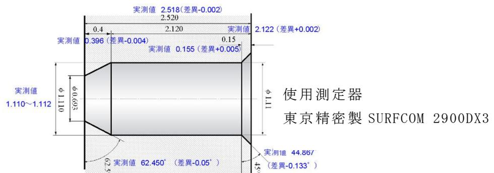
図 3-15 超合金製絞りメス金型の形状測定データ
