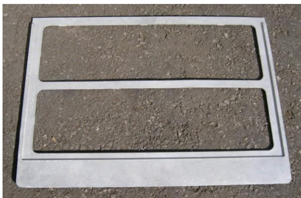
図 6.4 鑄造したドア部品粗材
