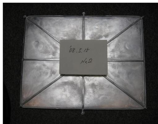
図 4.4 試作ダイカスト品の写真例
