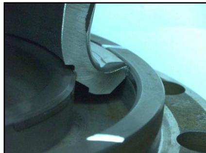
③静的振り破壊強度試験結果
