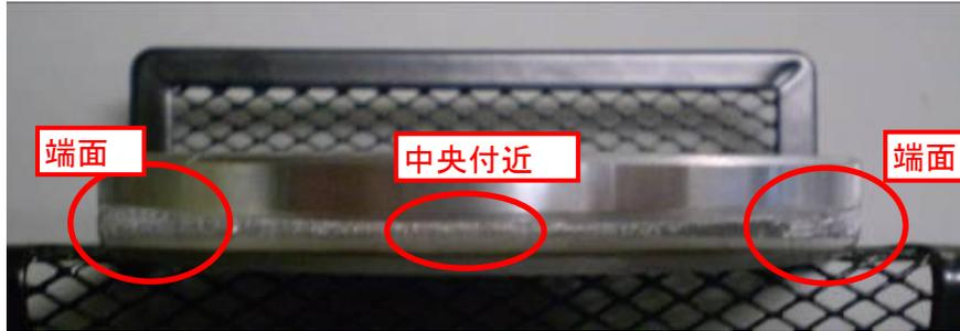
⇒リングマッシュ溶接接合面において、中央部付近の接合幅が両端に比べ少ない
