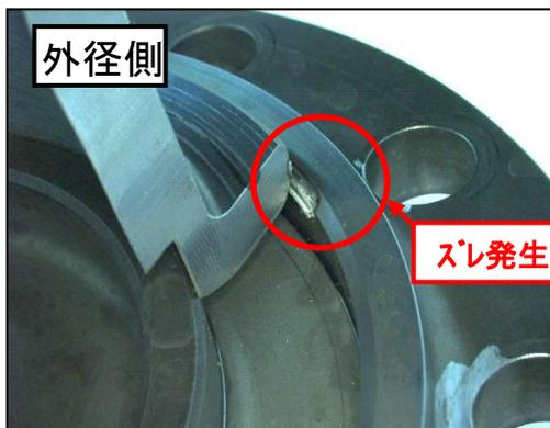
外周側はリングマッシュ接合にて結合しておりリングマッシュ溶接部から破損している。
