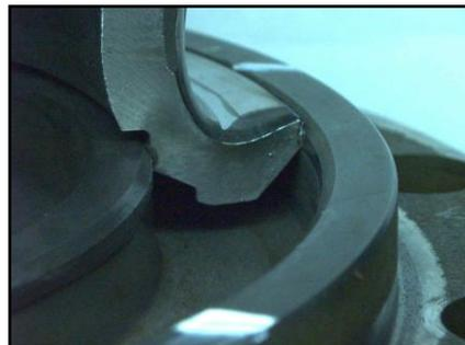
・反ピン側 溶接部端面①
