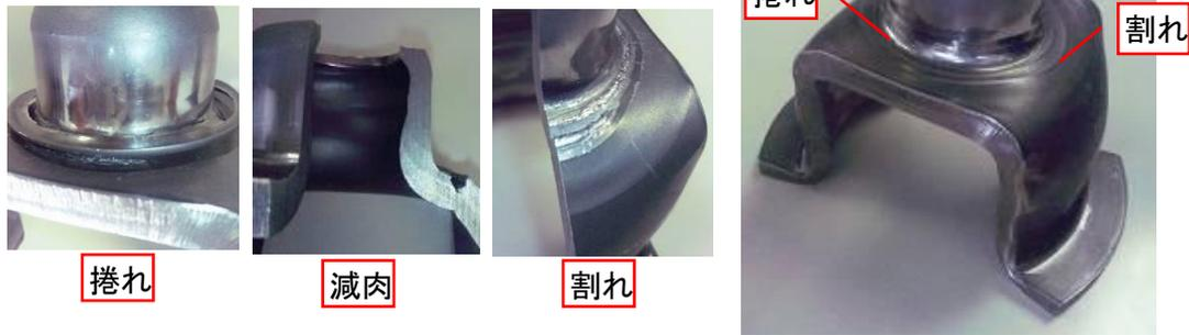
問題の対策として、金型パンチ・ダイRの拡大・表面処理の実施、絞り高さの変更をし再度トライ及び解析を実施した。対策の効果が確認できたのはボス高さのみで、他は改善が見られなかった。問題の原因として、捲れについては5DRでボスの外径がダイRによって削り取られた部分がボスの根元に押し詰められた。
