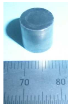
図 4-5 動的荷重を印加して焼結した Co 合金
