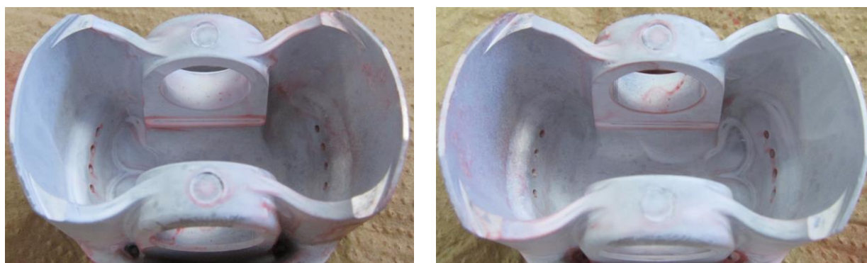
図 29 ピストン内圧試験品クラック確認結果(100時間終了後)
