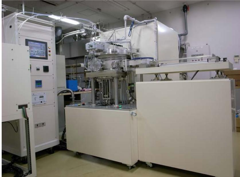
図 2-1 新規プラズマ CVD 装置（製品版装置）
