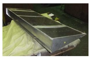
図2-15 摩擦攪拌接合で組立てた 航空機のエルロン(完成品)
