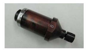
図2-6 両面摩擦攪拌接合ツール
