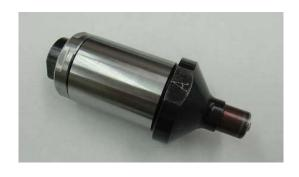
図2-7 片面摩擦攪拌接合ツール
