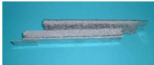
写真 2 - 8 せん断試験の破断後の試験片
