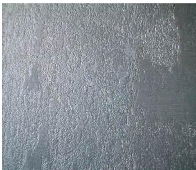
写真 2 - 8 水素雰囲気中で焼結したアルミ板の表面
