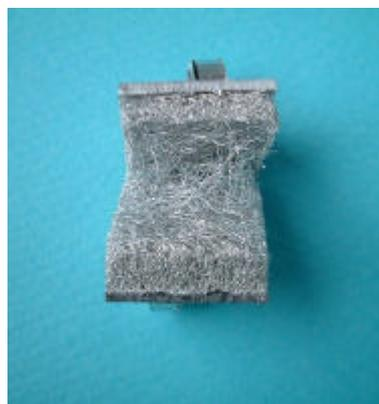
写真 2-6 引張り破断後の試験片
