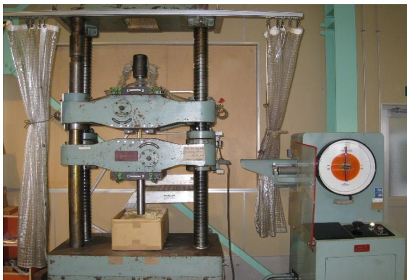
図 4-3-5 500kN アムスラー型引張試験機
