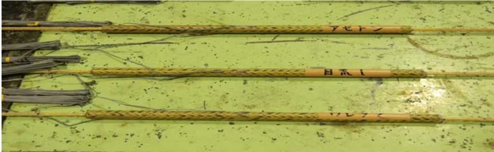
図 4-3-3 継手部引張試験前
