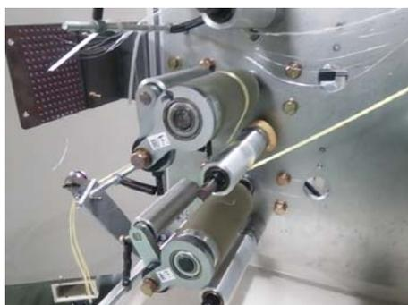
図 1-1-4 混織機ニップローラー
