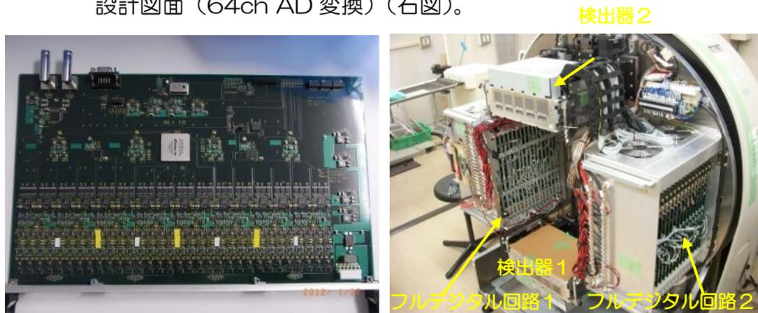
図3-2 フルデジタル回路。基板（64ch AD 変換）（左図）と、フルデジタル回路2台搭載高解像度 SPECT 装置（右図）。
