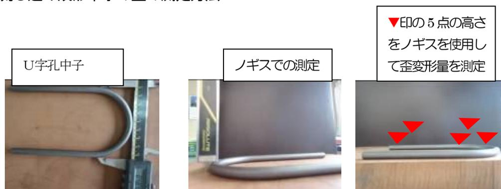
図 2-②-2 曲孔形状中子の歪量の測定
