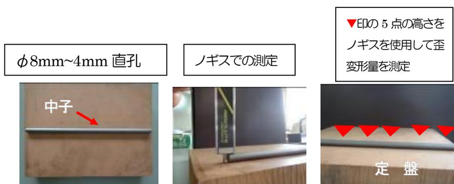
図2-②-1 直孔形状中子の歪測定
