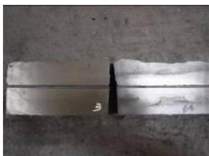
$\phi 8\text{mm}$ のU字孔カーボン中子を使用した鑄造品
