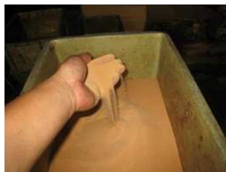
写真2：ゲル化処理を施したRCS
