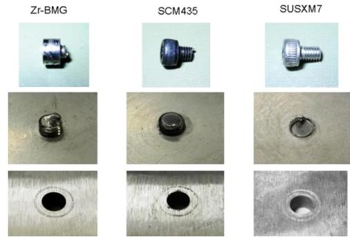
図④-2-5 ボルトの締め付け試験後の被締結材座面の外観
