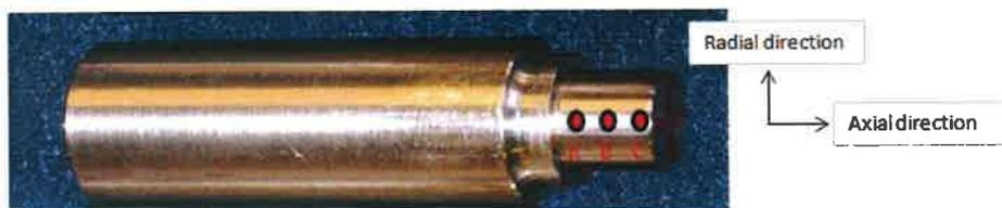
図 2-5-1 サンプル軸表面計測位置
