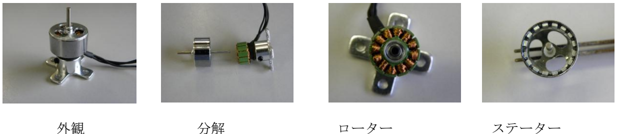
図 2-1-12 検討に使用したインスリンポンプ用試作 03 モータ
