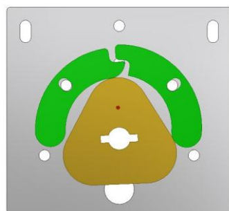
図 2-2-28 オムスピ型ローターポンプ
