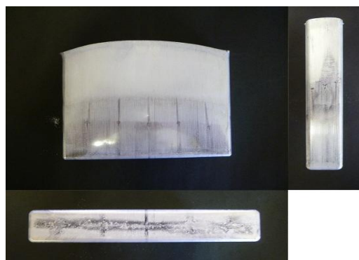
図 4-2-7 マーク付の成形品(lower surface)
