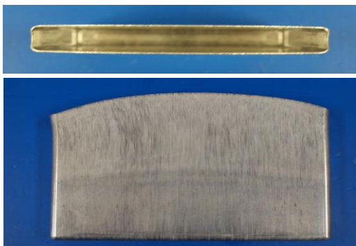
(図 2-1-3) 加工後の成形品形状と流動長推移
