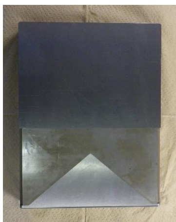
図 4-4-7 実験用ランド高さ変更パンチ
