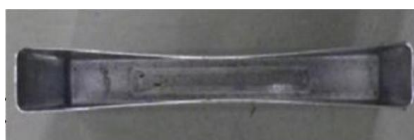
図 4-1-4 成形品の長辺側の凹み
